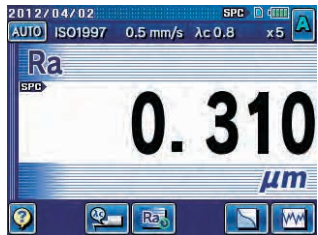
1-parameter display: one parameter measurement result
